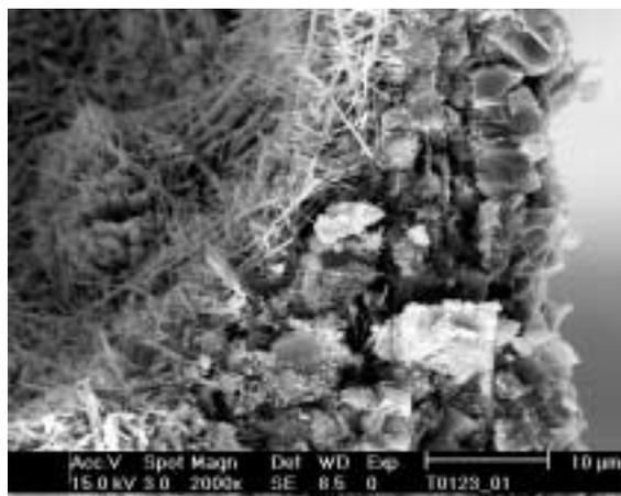
Abb. 4: REM-Querschnittaufnahmen einer Mörtelprobe (w/z = 0,60 und 0,5 m/z Stabilisatorzusatz), deren poröse Zementsteinstruktur bereits erste Anzeichen beginnender hydrolytischer Korrosion aufweist
